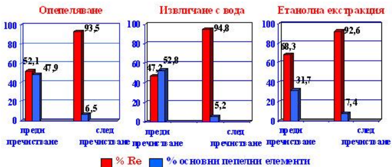
Фиг. 8. Процентно съдържание на Re и основни пепелни елементи в извличащите разтвори преди и след контакт на разтворите с катионит Dowex Wx8
