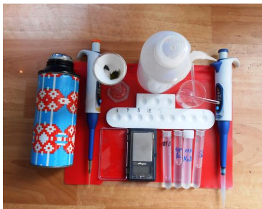
Фиг. 7. Оборудване, необходимо за определяне съдържанието на Re в сурова растителност при полеви условия
