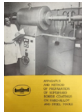
Фигура 2. Промислена инсталация за боридно покритие „БОР-6 Sm3“
