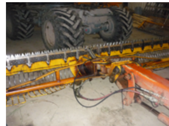
Фигура 5. Холандски стоманени режещи ножове, борирани посредством Паста „Борозар“ за подгряване на храсти и клони по каналите на страната
