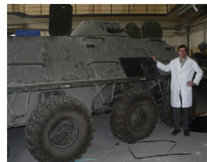
Фигура 7. Боркарбидни бронеплочки 500x500 мм за защита на „БТР“ в „Терем-Божурище“
